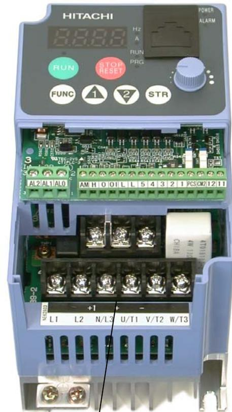
Bornes de raccordement du réseau et du moteur
