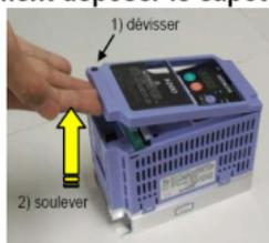
Le dépôt du capot principal du X200 est différente comparée aux modèles L100, L200 précédents. **Dévisser** d'abord la vis en bas à gauche du capot. Puis **soulever** le capot depuis le bas comme indiqué sur la photo ci contre.
